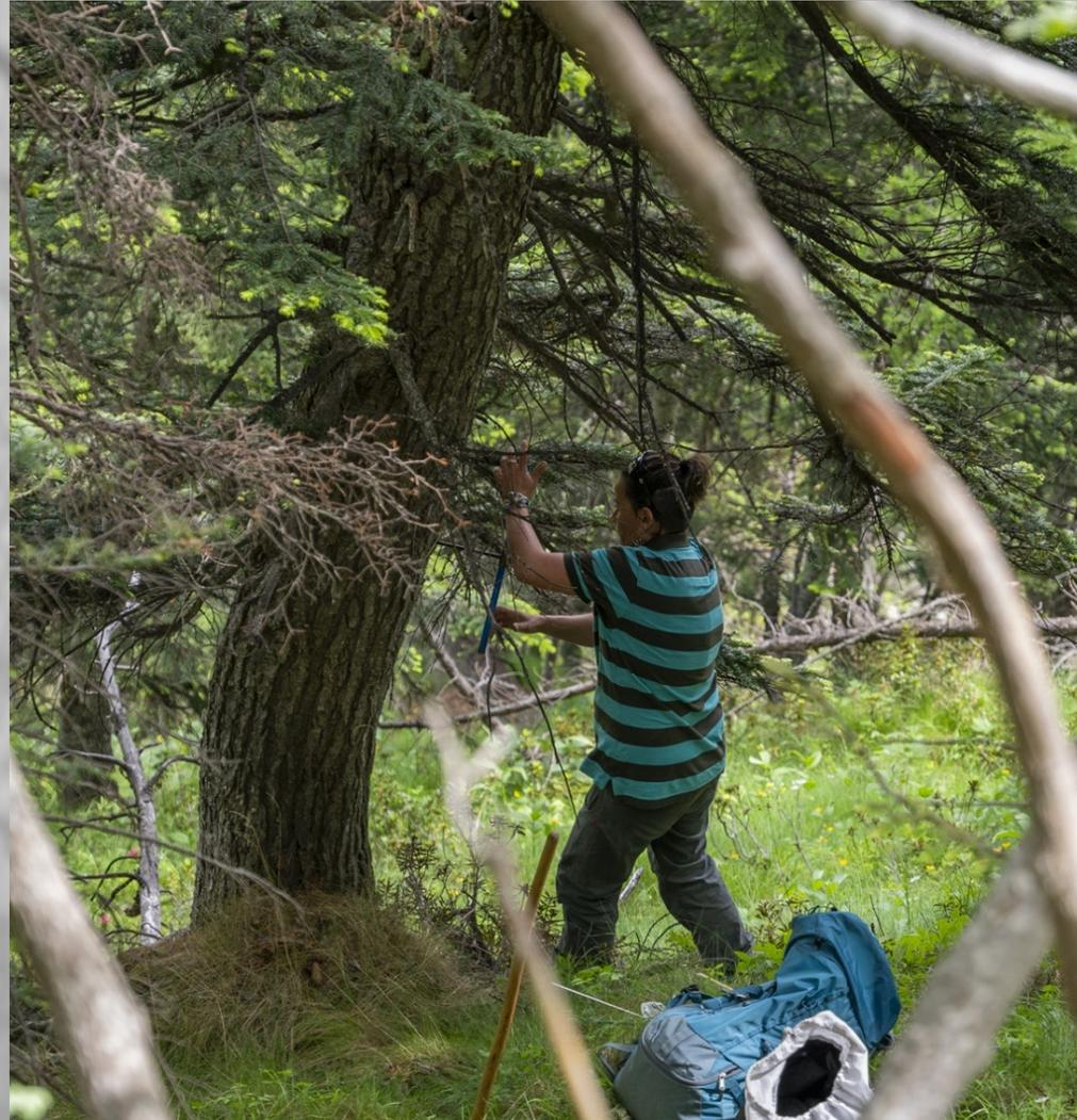
Carottage sur le terrain avec une tarière de Pressler
